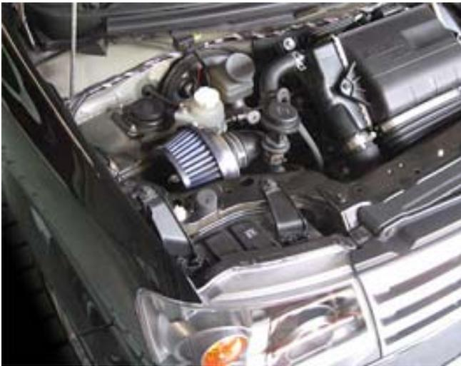
SUS POWER CORE TYPE LM装着画像
